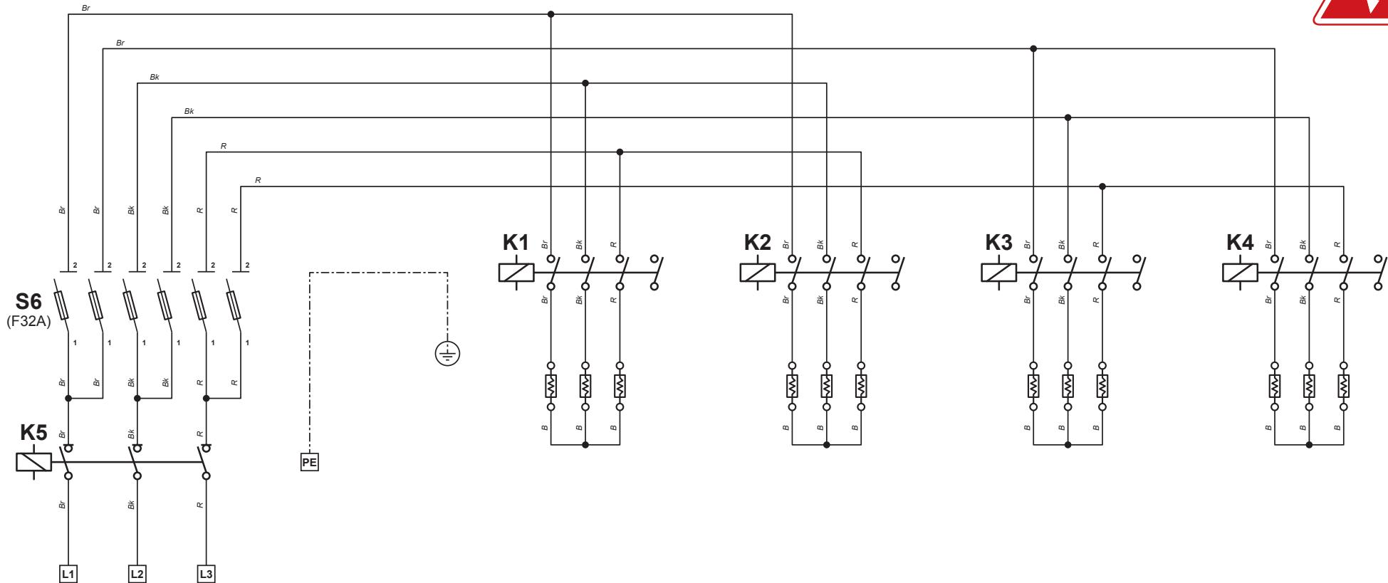
S6 : Клеммная колодка силовой цепи с предохранителями 32А
