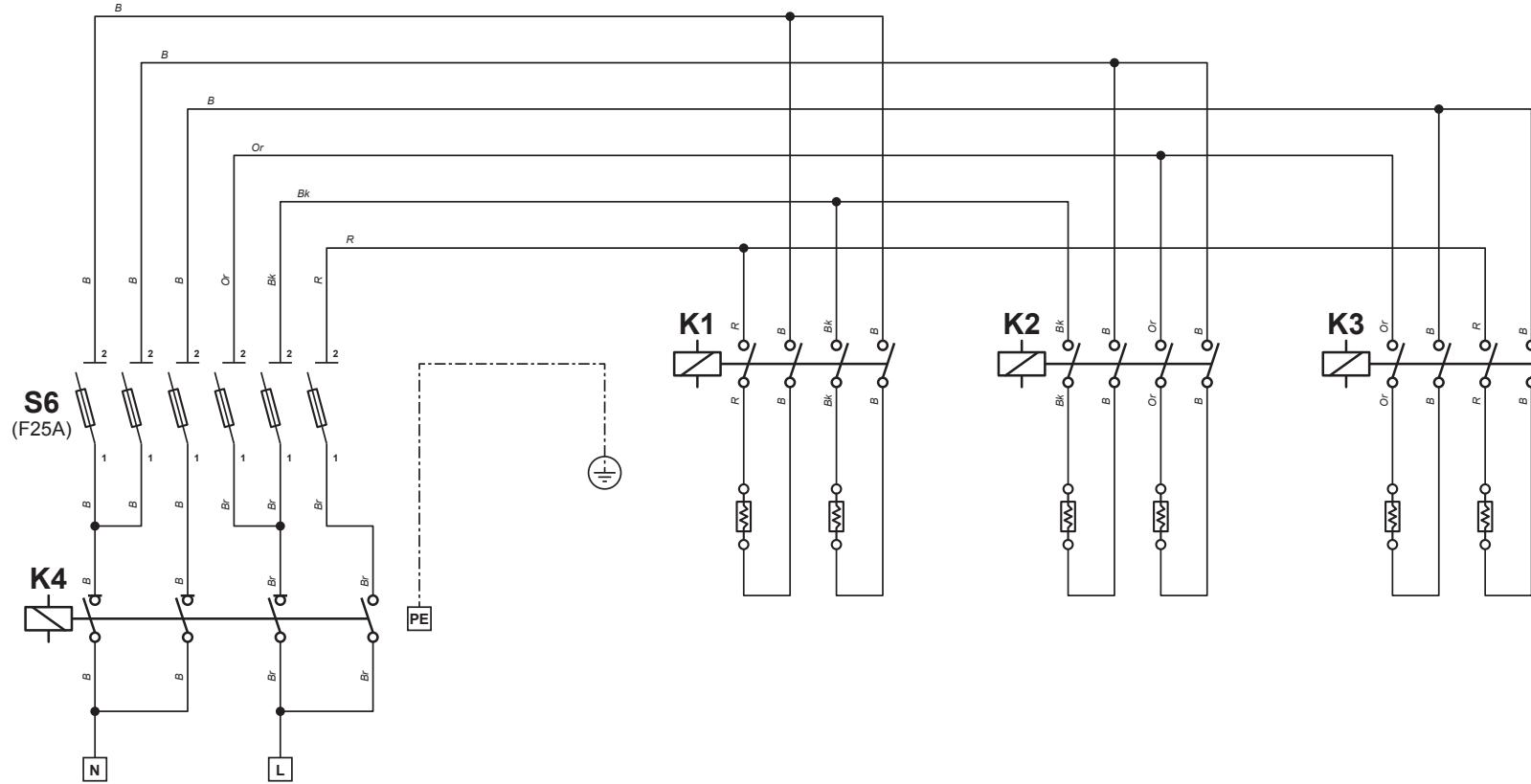
S6: Клеммная колодка силовой цепи с предохранителями 25A
